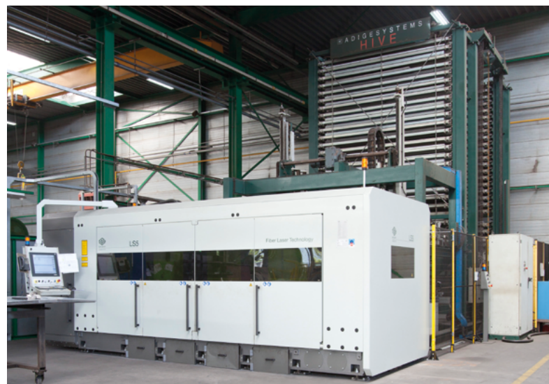
“Met de LT7EVO beschikken we over de nieuwste fiber lasertechnologie, de nieuwste generatie besturing, Active Tools features, een 2D snijkop en een magazijn voor 40 ton aan bulkaanvoer aan de achterzijde”
