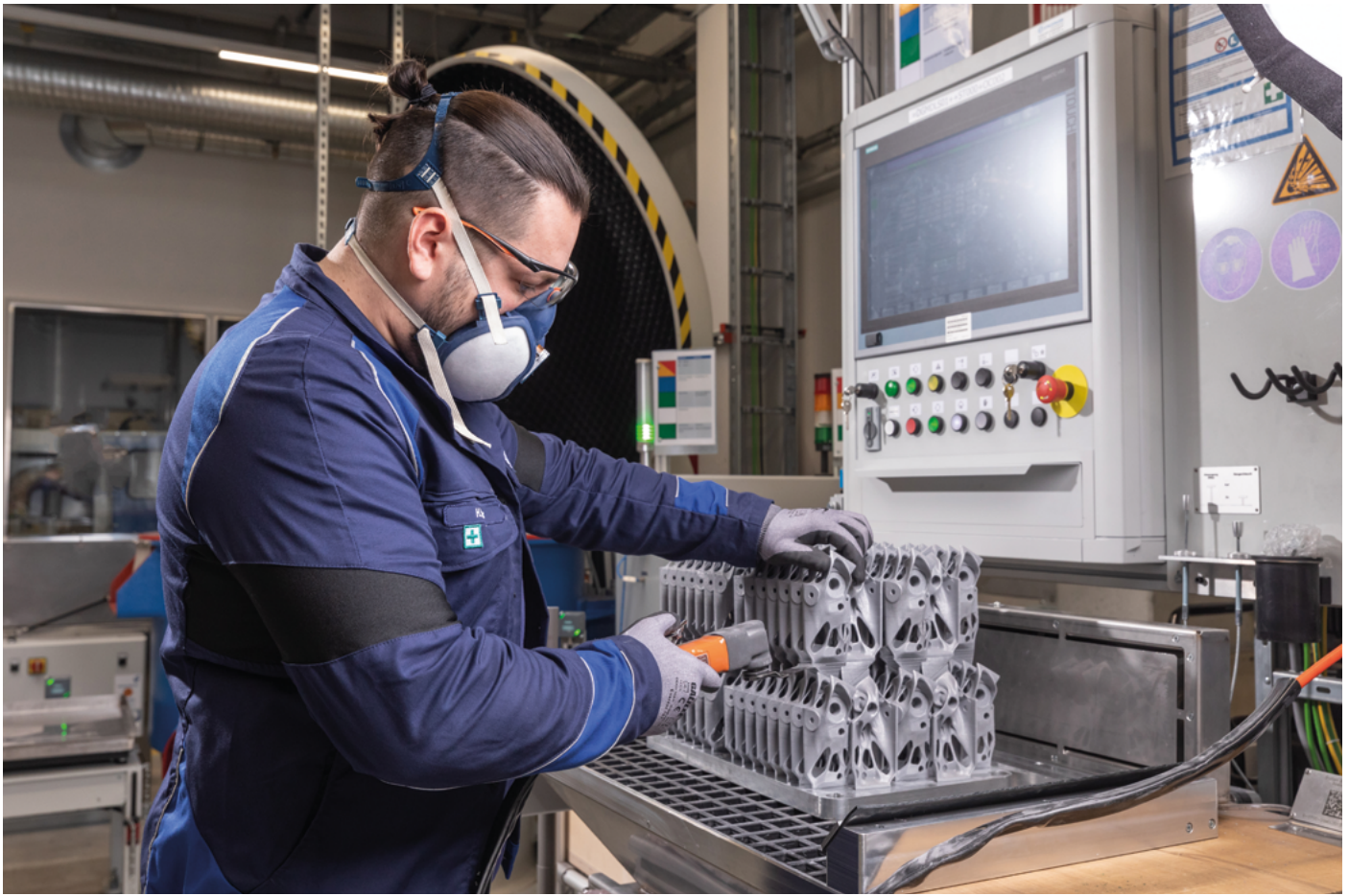
BMW 3D-print al metalen onderdelen voor onder andere de Rolls Royce-modellen.
